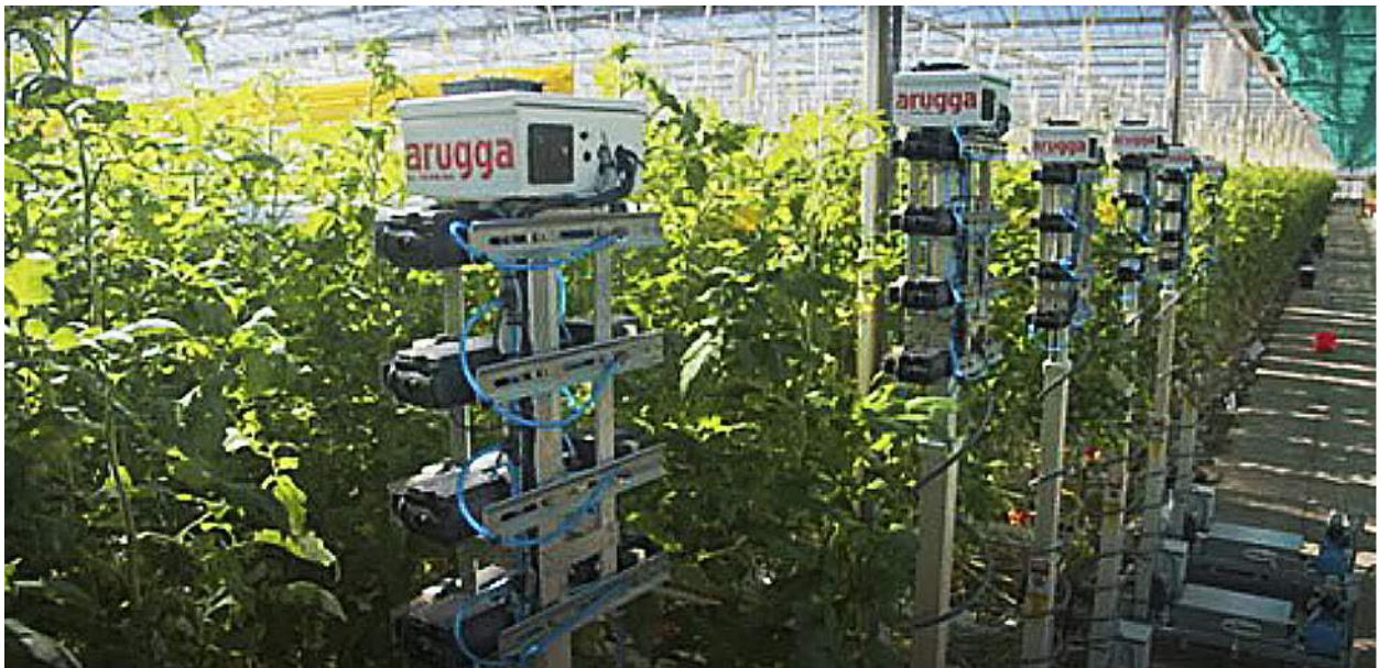
El Polly utilizado en hileras de plantas de tomate en invernaderos. Cortesía
